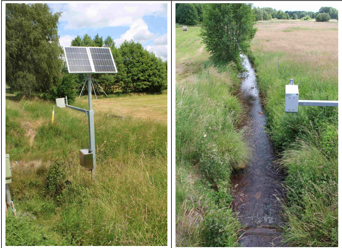
Fotos 1 und 2: Messeinrichtung zur Bestimmung der Fließgeschwindigkeit am Nordbach bei Salzhausen
