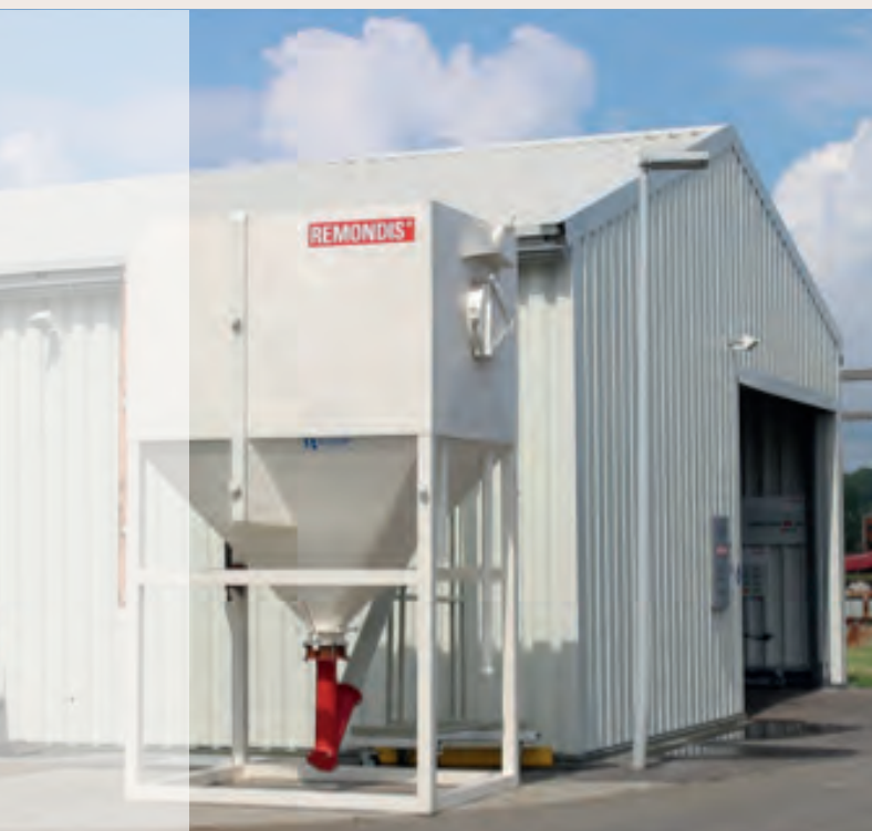
Abbildung 42: Remondis TetraPhos®-Pilotanlage bei HAMBURG WASSER
