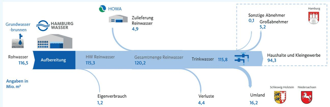
**Abbildung 3-3: Sankey-Diagramm von der Rohwassergewinnung zur Wasserabgabe in Mio. m<sup>3</sup>**
