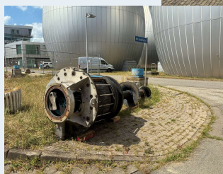
Externe Umwälzung (Mischer) mit Ortsteuerstelle (Ex)
