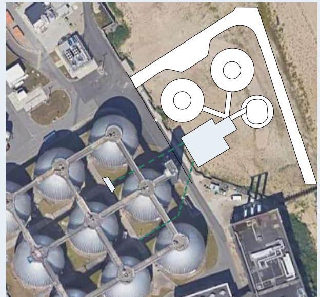
Lageplan der Faulbehälter
